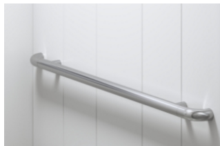
Optionaler Handlauf aus gebürstetem Edelstahl EN 81-70 mit zur Wand gebogenen Enden, 40 mm Durchmesser
