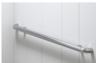
Corrimão opcional EN 81-70 em aço inoxidável escovado com extremidades curvas, 40 mm de diâmetro
